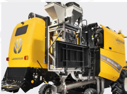
Potente sistema de pesaje Twin H2 con HarvestMaster, que proporciona datos de peso, humedad y peso volumétrico precisos
