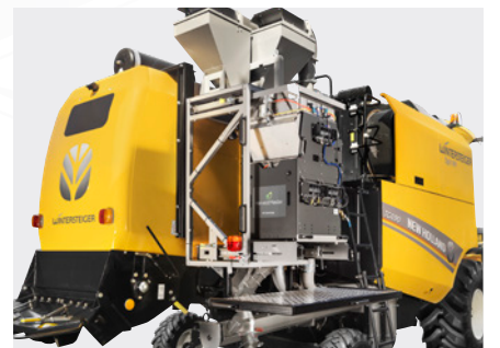
Potente sistema de pesaje Twin H2 con HarvestMaster, que proporciona datos de peso, humedad y peso volumétrico precisos
