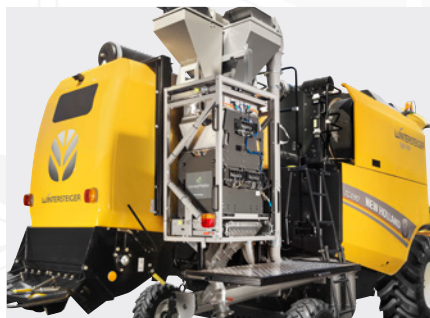
Potente sistema de pesaje Twin H2 con HarvestMaster, que proporciona datos de peso, humedad y peso volumétrico precisos
