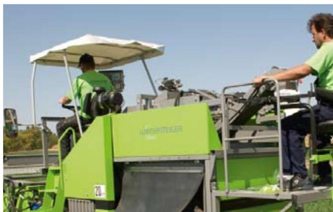
确保了准确的将收获的作物输送到箱内，并在整个称重过程不会受到外界风力的影响。
