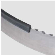
锯条进行保养维护工作时的锯齿保护
