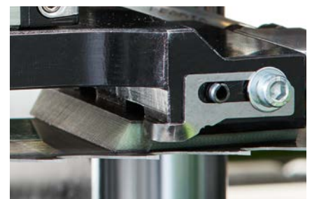
高科技碳枕式锯条导向设计极具抗磨损能力
